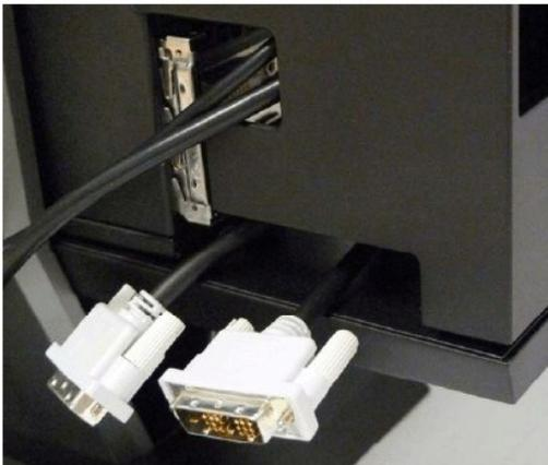
Cheminement du dongle à travers la nouvelle ouverture
